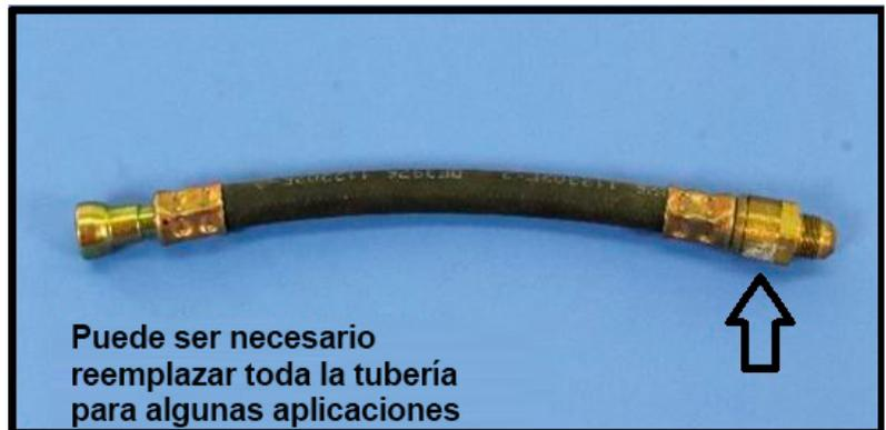
La conexión roscada tendrá una flecha y la palabra flow (flujo), que identifica la bola y el resorte unidireccionales. Se debe reemplazar la tubería del enfriador de retorno que contiene la bola y el resorte unidireccionales.
